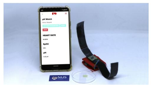
図1 NUS チームのカスタム pH センサ(中央)と pH センシングアルゴリズムを、すでにパルス酸素濃度計を組み込んでいる既存のフィットネストラッカーやスマートウォッチに組み込むことで pH Watch はユーザの汗の pH 値と心拍数、血中酸素飽和度もリアルタイムで同時モニタできる。
