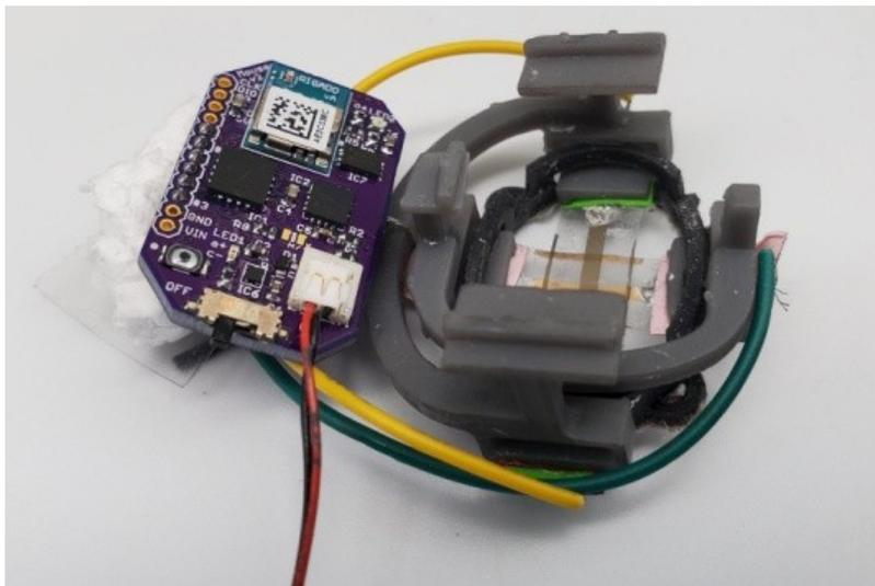
図 1 FAST システムは、腫瘍サイズ逆行を計測する。抗ガン剤の有効性をテストする新方法 (Image credit: Alex Abramson, Bao Group, Stanford University)
