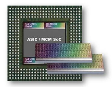
BlueJay は、ホストサイドで、超低消費電力バンチ・オブ・ワイヤ (BoW) ダイ・ツー・ダイ (die-to-die) インタフェースを使い、MCM SoC(system-on-chip)コアと通信する。ワイドバス BoW インタフェースは、TSMC CoWoS パッケージングに最適化されている。これは、ハイパフォーマンスコンピューティング (HPC)アプリケーション向けに設計されたものである。ラインサイドでは、チップレットは、64 レーンの低消費電力 56G PAM4 LR SerDes を持ち、MCM にロバスト、オフパッケージインタフェースを提供。これにより、様々なシステムレベル構成で組込が容易になる。
